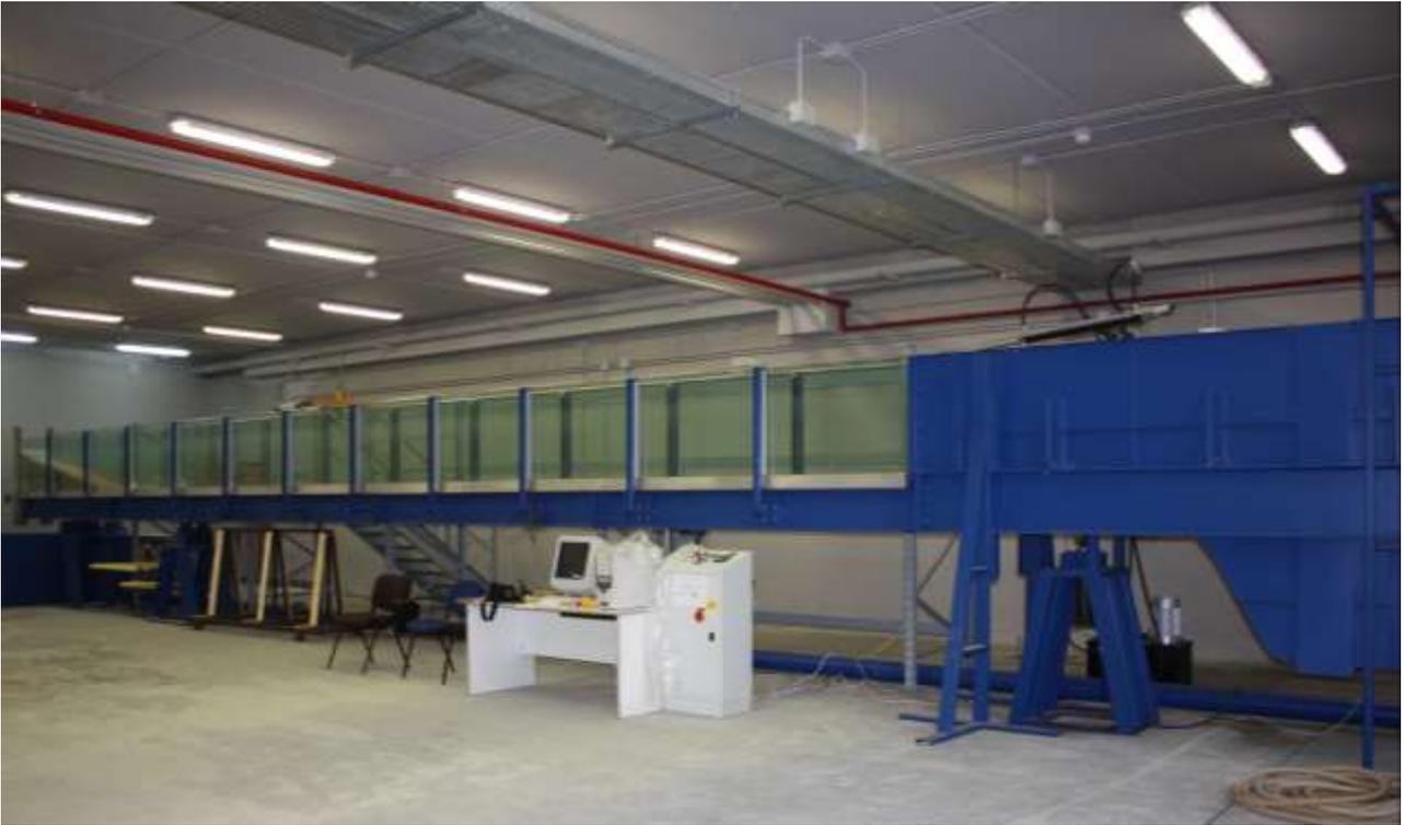
Figura 1. Canaletta a fondo inclinabile con sistema di controllo
