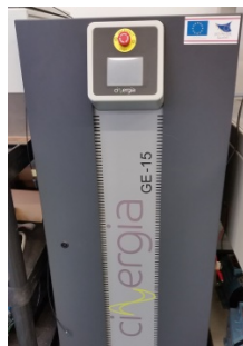
Emulatore di rete Cnergia GE- 15kVA
