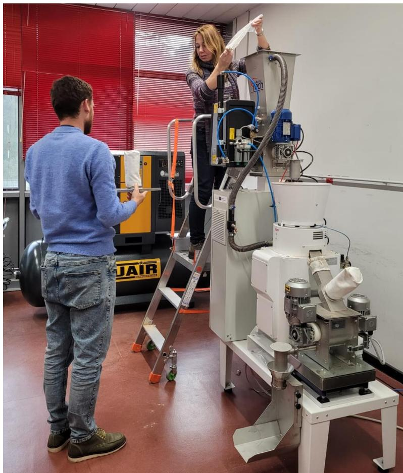
Fig.2- Sistema di caricamento dall'alto dello scarto - Top loading system for waste
