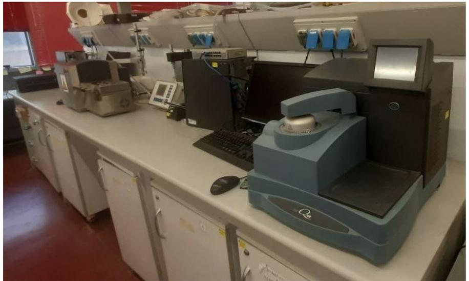
Da sx verso dx: mini-estrusore da laboratorio, durometro Shore-D, Calorimetro DSC
