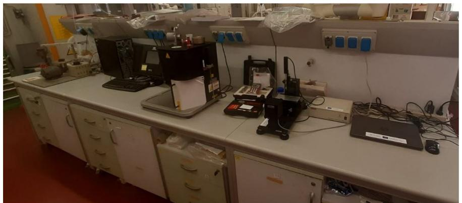
Da sx verso dx: prototipo per rilevazione usura, indice di flusso, stazione di prova di misure superficiali (cross-cut test, rugosimetro, prototipo per la misurazione della bagnabilità e spessimetro).
