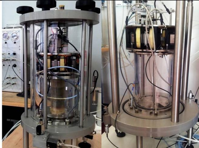
Fig. 3 - Attrezzature per l'esecuzione di prove di colonna
